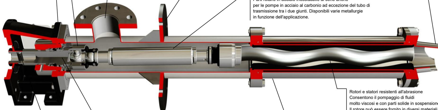
Vari sistemi di tenuta disponibili tra cui: Baderna flussata, tenuta meccanica con quench, tenuta doppia contrapposta e tandem. Le tenute in quench e doppie vanno flussate secondo gli API PLAN idonei al processo. È inoltre possibile installare una vasta gamma di tenute a norma ISO EN 12756 in modo da soddisfare ogni esigenza applicativa. Di serie tenuta meccanica singola con quench
